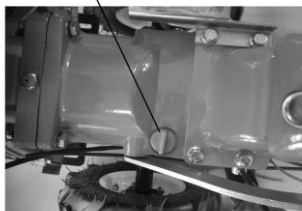
Sl. 5 –Proveravanje nivoa ulja u menjaču
